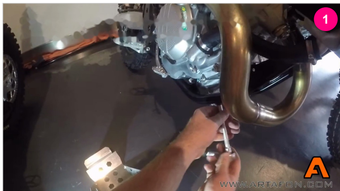
ODKRĘCAMY OEMOWE ŚRUBY OD RAMY
