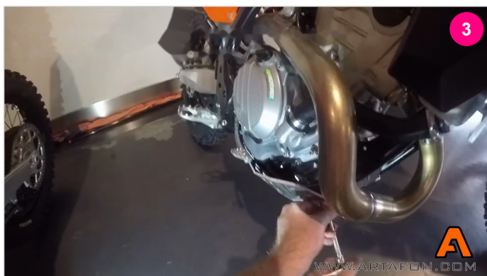
PRZYKRĘCAMY ŚRUBY MOCUJĄCE OSŁONĘ
