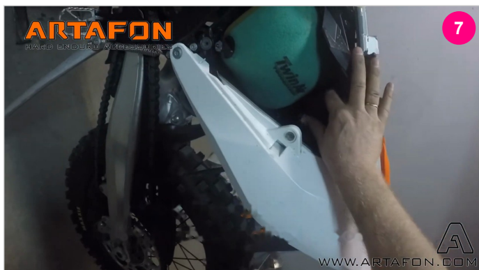
ZACZEPIAMY GUMĘ / PRZEKAŹNIK W ORYGINALNYM MIEJSCU
