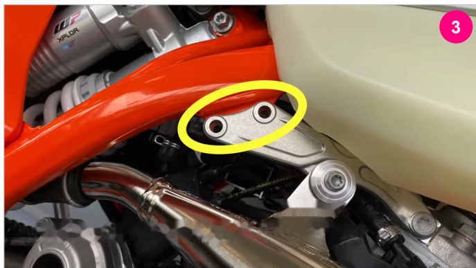
ODKRĘCAMY ŚRUBY Z RAMY
