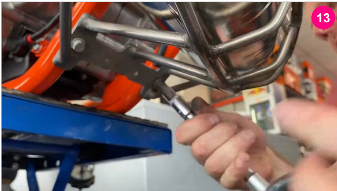
ALLE SCHRAUBEN WECHSELWEISE FESTZIEHEN
