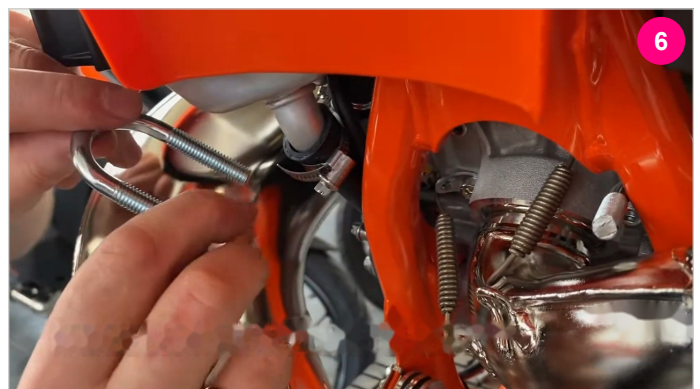
LANGEN HALTER VON LINKS AUFSETZEN
