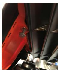
TIGHTEN THE SIDE PLASTIC AND SCREW REMAINING SCREWS ON THE TANK.
